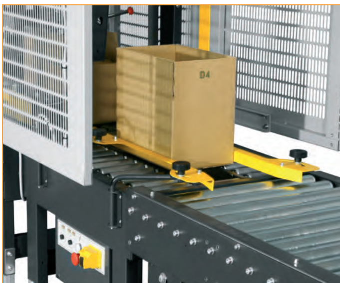
AG21 Motorisierte Indexierungseinheit mit Zeitsteuerung (Option)
