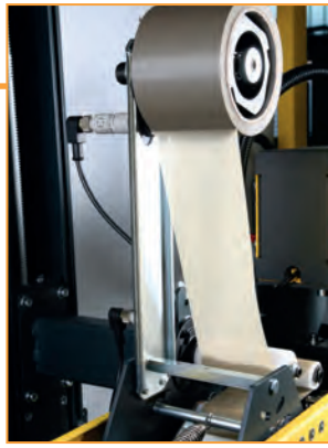
Sensoreinrichtung für niedriges Klebeband/kein Klebeband (optional)
